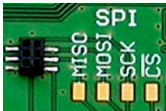
图 30 SPI 的接线场
