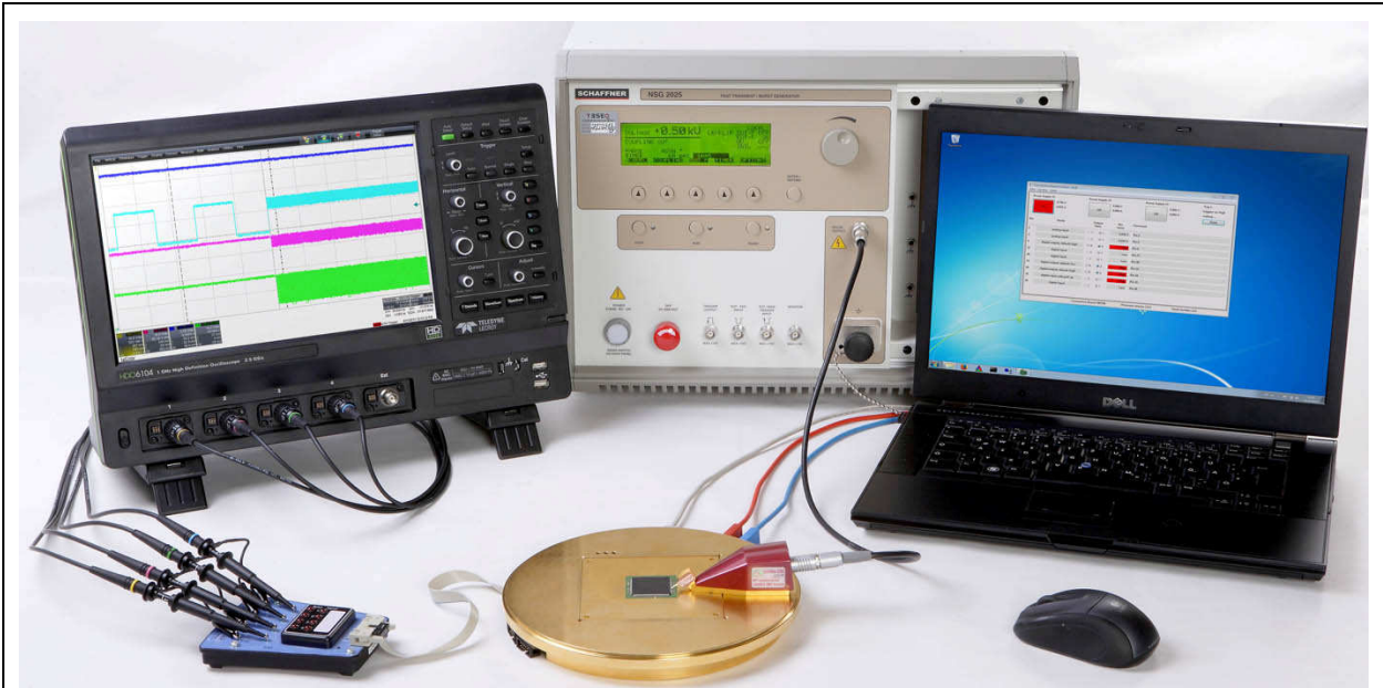
图 22 示波器适配器 OA 4005 的应用，测试装置包括 P250 探头组及 ICE1 套组
