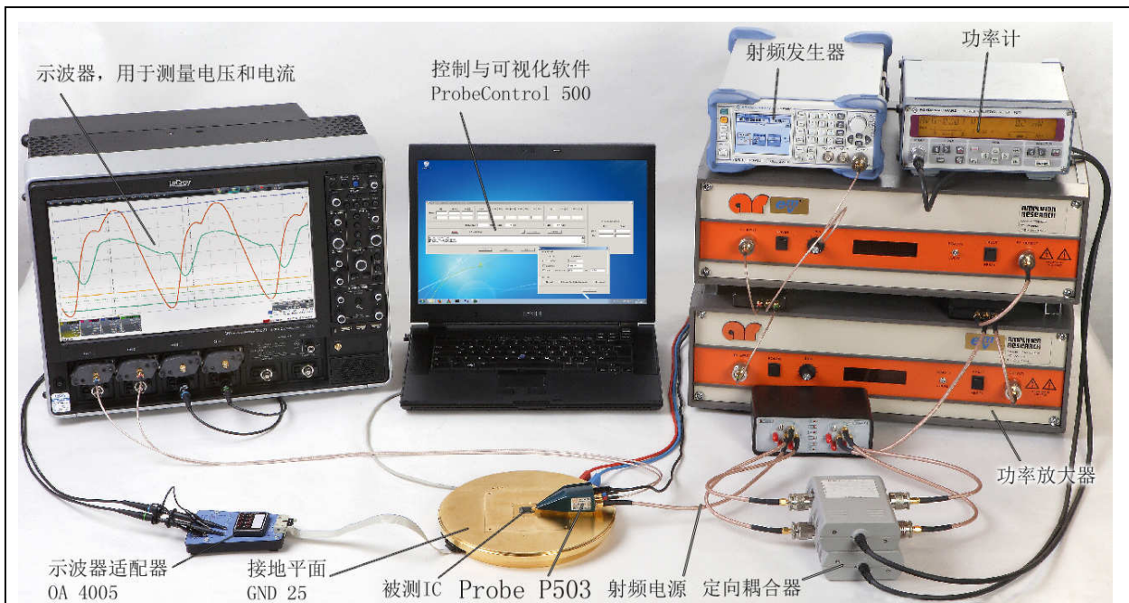
图 20 P500 探头组、ICE1 套组以及外部仪器组成的测试装置
